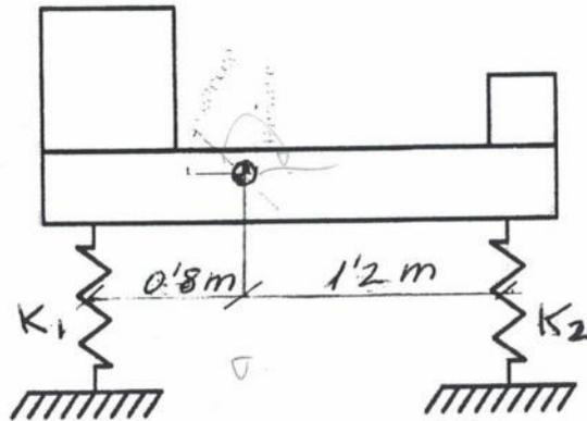
1º La figura representa el esquema dinámico idealizado de un torno, donde se designa por  $M$  la masa total del torno y por  $I_p$  el momento de inercia respecto al eje que pasa por su centro de masa.
